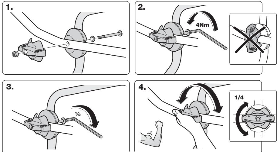
**S** 1. Montera vredet enl. bild. 2. Dra åt skruven tills det inte går att lossa vredet med handkraft. 3-4. Lossa skruven 1/2 varv i taget tills man med handkraft kan vrida vredet (**vredet shall gå trögt när det lossas**).
