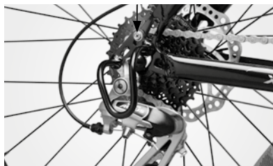
Växelskydd monterat med en bult
