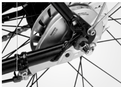
Justera bromsjusteringskruven bak
