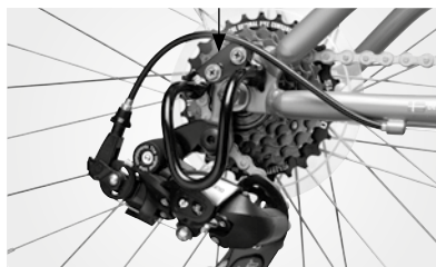
Växelskydd monterat med en bult
