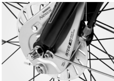
Justera bromsjusteringskruven fram
