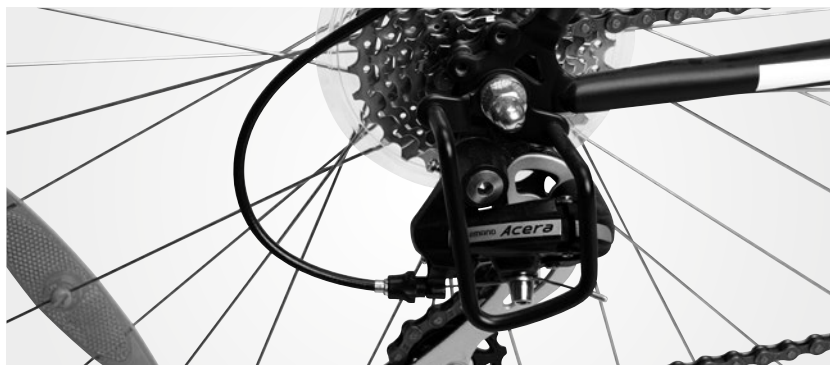
Växelskydd monterat på externa växlar
