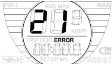
Batteriet er tomt og symbolet E blinker.
