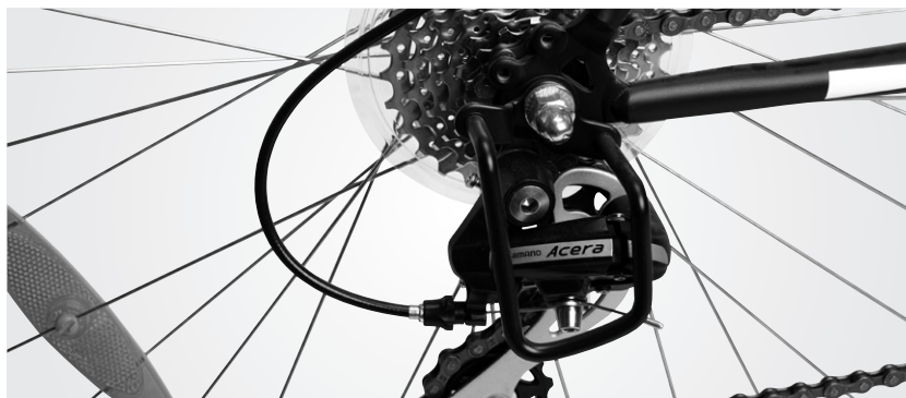
Gearbeskytter monteret på udvendige gear
