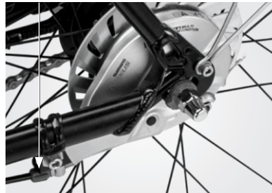
Justerskruen for justering af bremse bag
