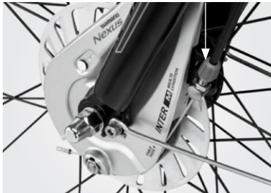
Justerskruen for justering af bremse for
