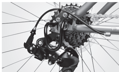
Gearbeskytter monteret vha. én bolt
