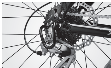
Gearbeskytter monteret vha. én bolt
