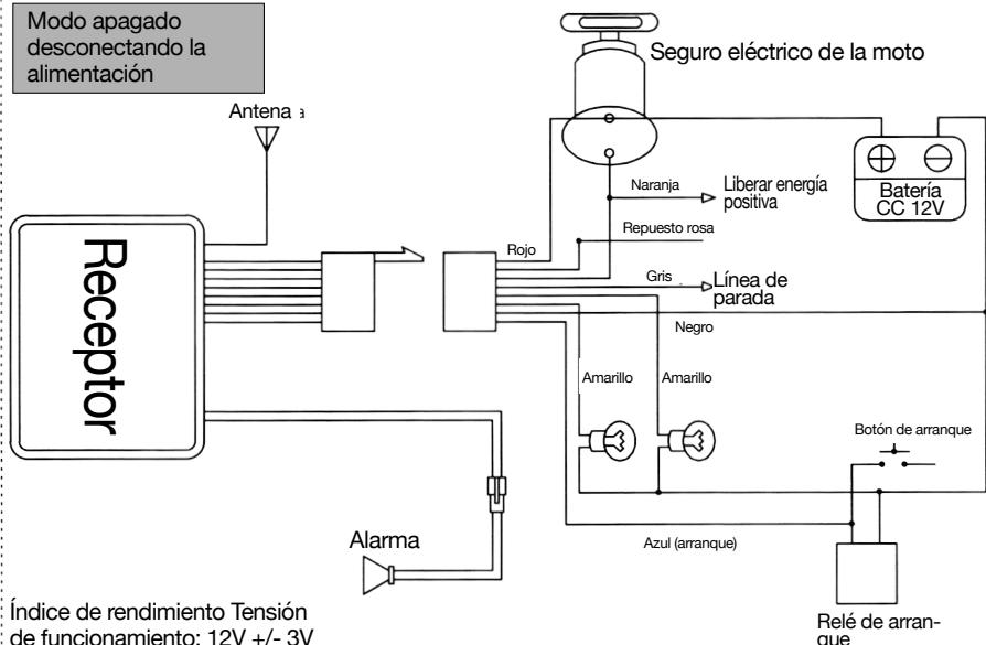
Índice de rendimiento Tensión de funcionamiento: 12V +/- 3V
