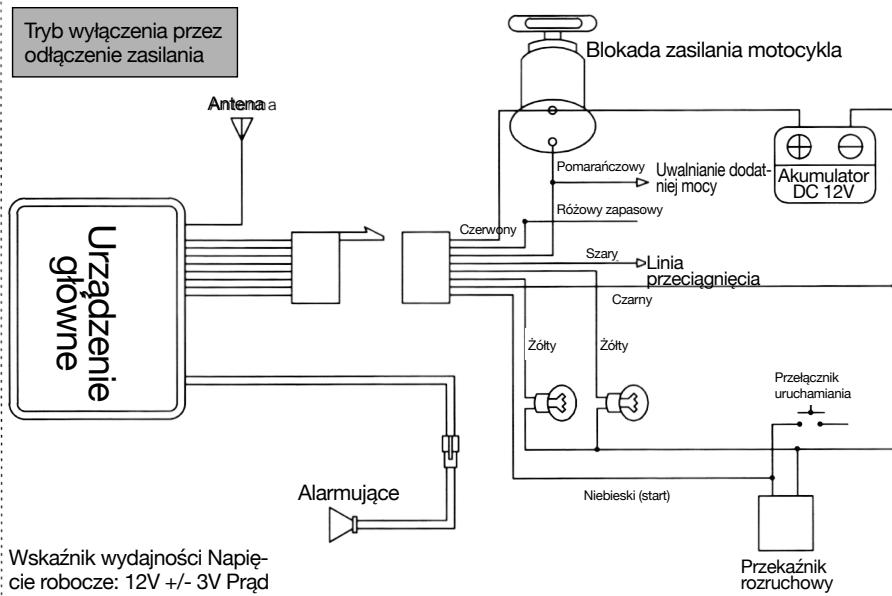
Wskaźnik wydajności Napięcie robocze: 12V +/- 3V Prąd statyczny: ≤8,5 mAh
