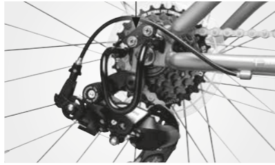
Girbeskytter montert med én bolt
