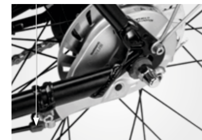
Justeringskrue for justering av bakbrems
