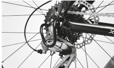
Girbeskytter montert med én bolt
