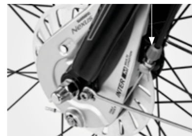
Justeringskrue for justering av forbrems
