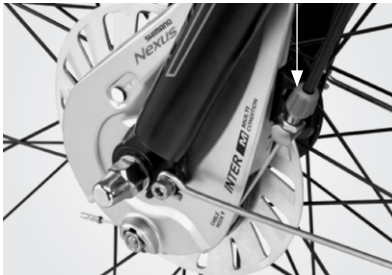
Justeringsskruer for justering av forbremser
