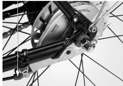
Justeringsskruer for justering av bakbremser
