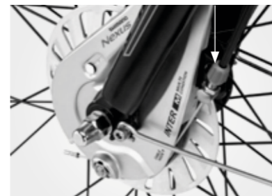
Justera bromsjusteringskruven fram
