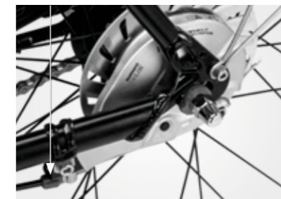
Justera bromsjusteringskruven bak
