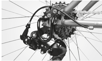
Gearbeskytter monteret vha. én bolt
