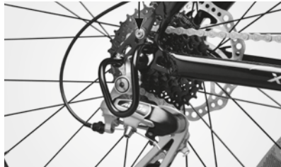
Gearbeskytter monteret vha. én bolt
