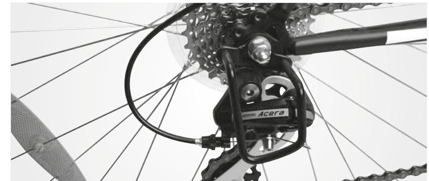
Gearbeskytter monteret på udvendige gear
